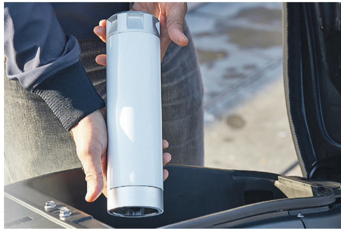
Les cartouches, de la taille d'une canette, peuvent remplacer les batteries électriques pour des véhicules de moins d'une tonne.
